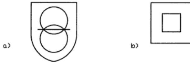
**Fig. 7.2** Simboli per il contrassegno di apparecchi: a) trasformatore di sicurezza; b) con doppio isolamento.
